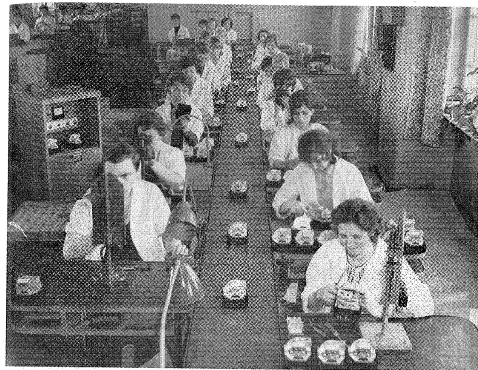
Rys. 3.83. Taśma montażowa liczników
