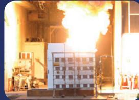
Ensayo de fallo de arco interno
