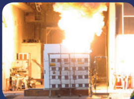
Испытание защиты от электрической дуги распределительного устройства Email: zwarcia@iel.waw.pl
