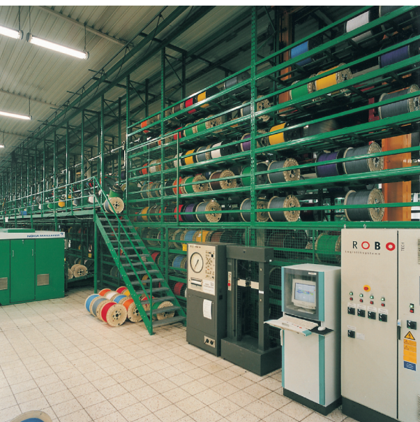
Ryc. 4.1.3 Magazyn automatyczny z żyłami kabli telekomunikacyjnych
