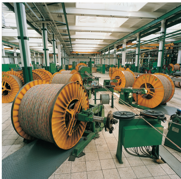
Ryc. 4.1.7 Linia technologiczna skręcania ośrodka
