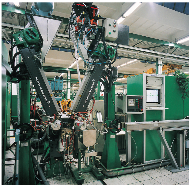
Ryc. 4.1.6 Linie technologiczne wytłaczania żył kabli telekomunikacyjnych
