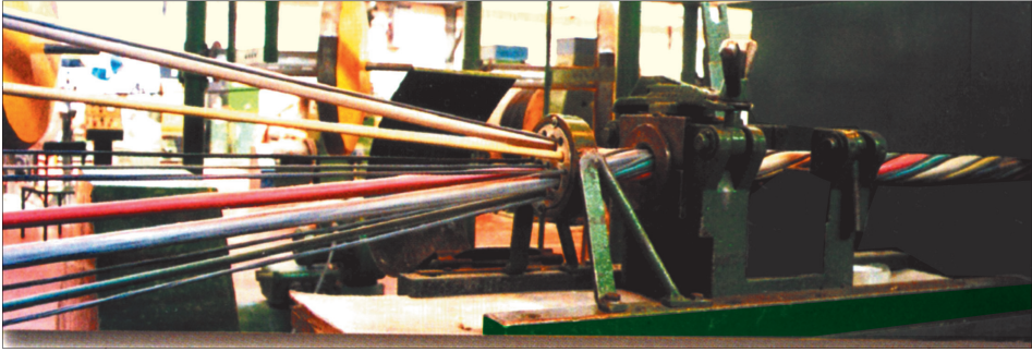
Ryc. 4.1.16 Produkcja kabli silnoprądowych
