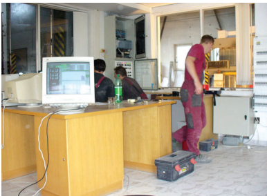
Widok laboratorium – komputer rejestrujący przebieg badań ogniowych trasy kablowej
