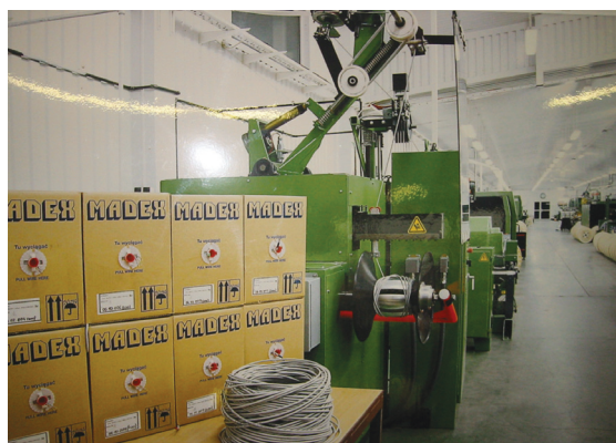
Ryc. 4.21.4 Konfekcjonowanie kabli komputerowych
