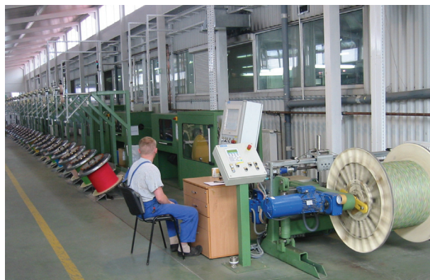
Ryc. 4.21.5 Linia ze skrecarką typu S-Z
